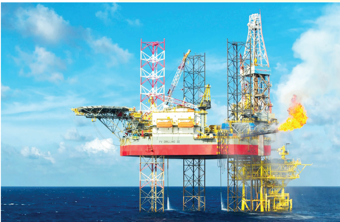
Giàn khoan tự nâng PV DRILLING III
